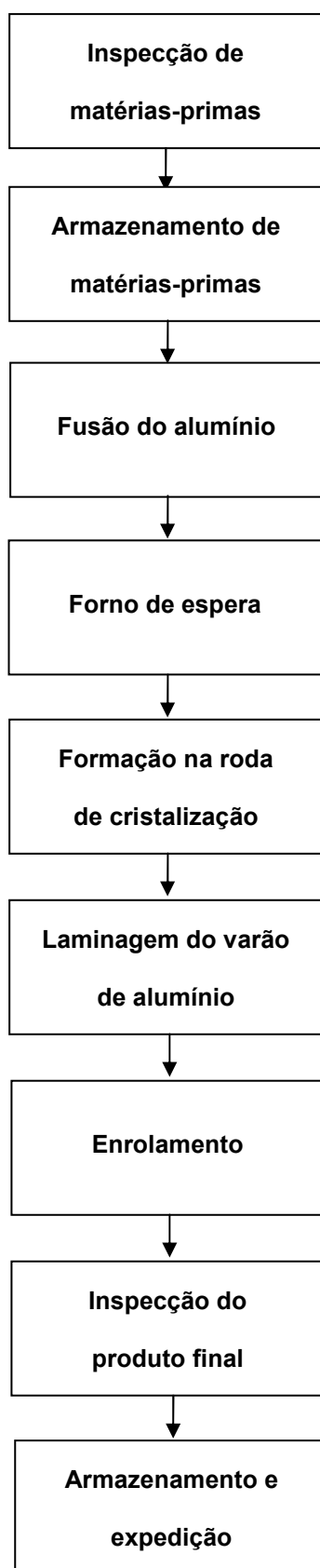
Figura 3 – Diagrama da actividade de produção de fio máquina (varão) de alumínio.
